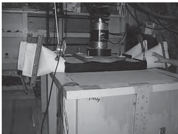
写真-1 埋設載荷試験機（エアバック仕様）
