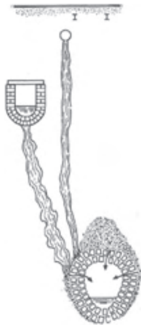
図-19 英国レンガ管崩壊メカニズムの概念図
