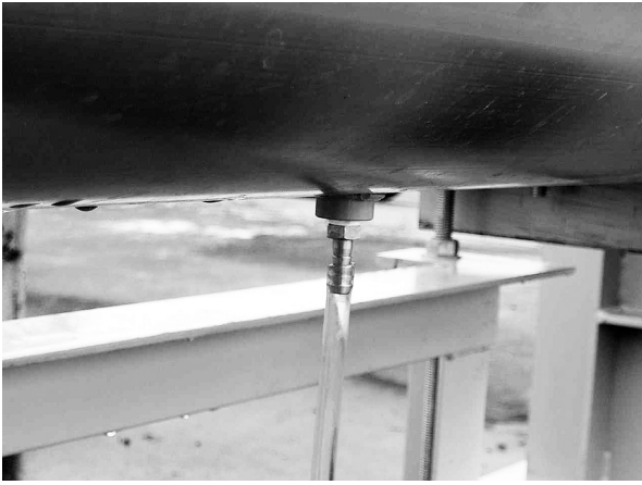
写真-3 ピエゾメーター、連結ホース
