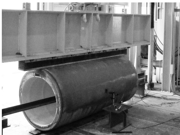
写真-1 外圧試験状況
