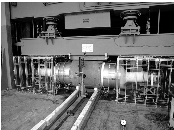
写真-1 内圧バッグを用いた内外圧試験状況
