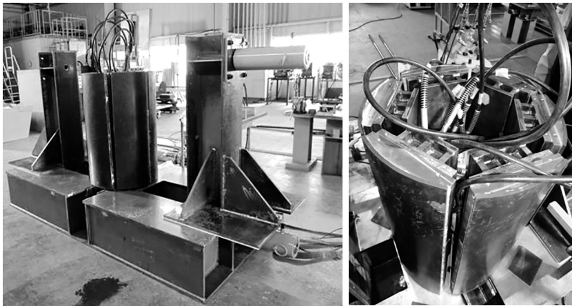
写真-2 ジャッキ方式内外圧試験機
