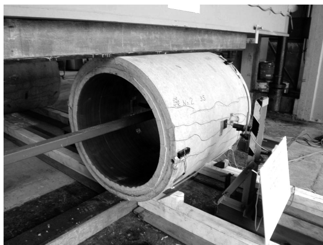
写真-2 更生管 (A 工法) の繰り返し载荷後の外圧試験状況
