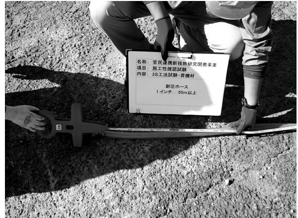
写真-3 充填ホース計測状況
