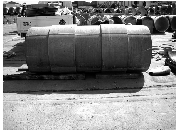
模擬管路脱型後
