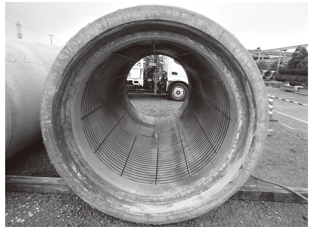
写真1 鉄筋露出が著しい20mm減肉新管の例
